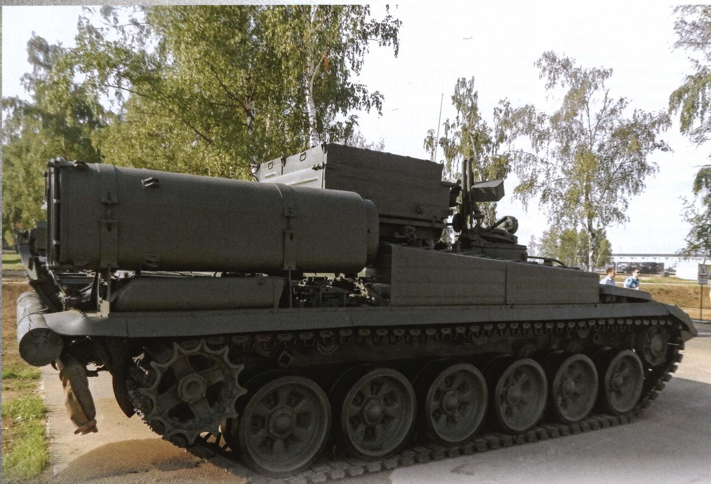
БРЭМ-1, вид справа. Хорошо видны труба ОПВТ и ящик ЗИП.
