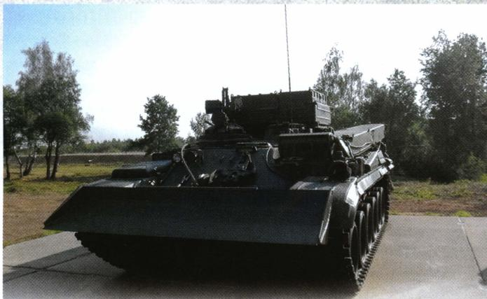
БРЭМ-1, вид спереди. Хорошо виден сошник-бульдозер, предназначенный для упора машины при эвакуации застрявших танков. При необходимости его можно использовать для проведения земляных работ.
